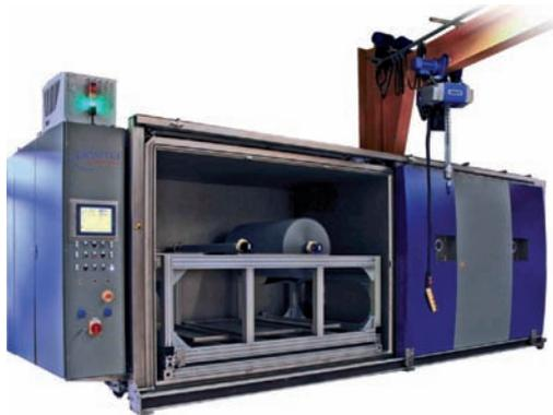
Niederdruckplasmaanlage mit einem Kammervolumen von rund 10 m<sup>3</sup> zur Aktivierung von Folien. © plasma technology GmbH.
