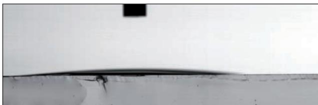
Der Kontaktwinkel eines Wassertropfens auf einer Glasfläche vor deren Reinigung im Niederdruckplasma. Er liegt hier bei etwa 35°.
