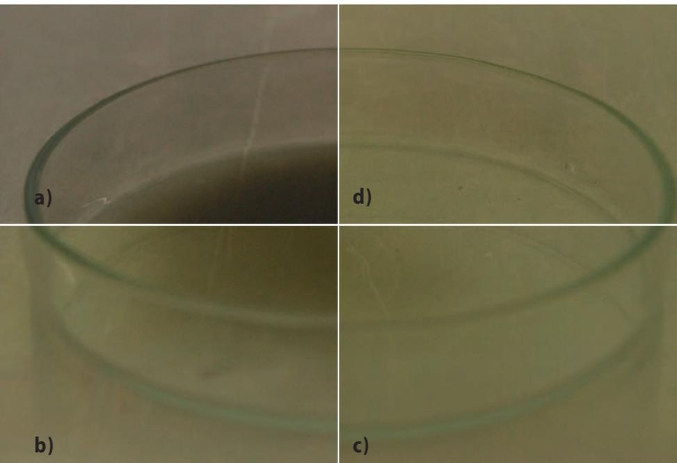
Blick in die Plasmakammer während der Reinigung einer berußten Glasschale im Niederdruckplasma; Bildausschnitte: a) Start; b) nach 45 Sekunden; c) nach 90 Sekunden; d) gereinigte Glasoberfläche nach 120 Sekunden.
