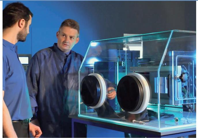
Die Glovebox dient dazu, eine Kontamination der Plasmakammer mit Umgebungsluft zu verhindern und die bereits gereinigten Materialien von Umgebungseinflüssen abzuschirmen.
