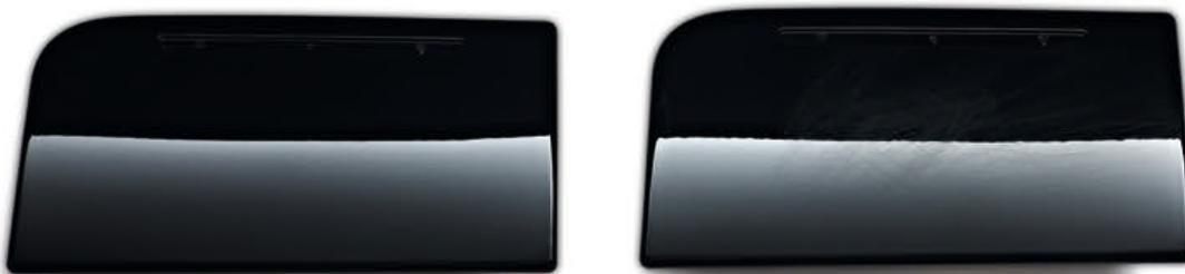
**Bild 6. Links: Kratztest nicht in Ordnung, rechts: Kratztest nach plasmapolymere Beschichtung in Ordnung** (Bild: Sommer Industrielackierung)
