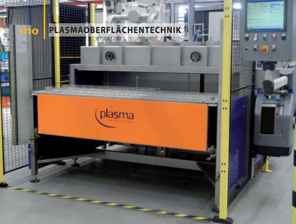
Um die Anlage so kompakt wie möglich zu halten, werden Kammer, Vakuumpumpe und Steuerung in einem einzigen Gehäuse untergebracht. Bild: plasma technology
