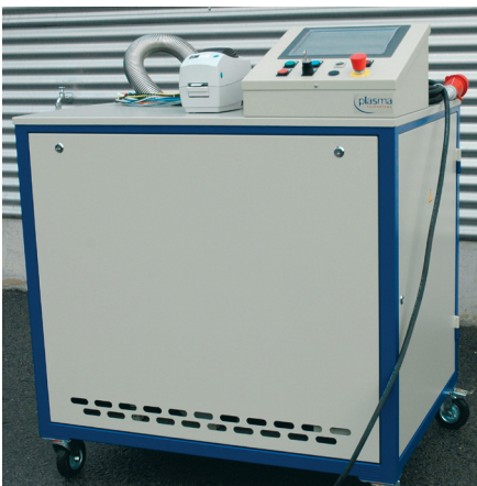
▮ Abb. 4: Verfahrbare Versorgungseinheit für das Plasma-Spot®-System Bild: plasma technology GmbH
