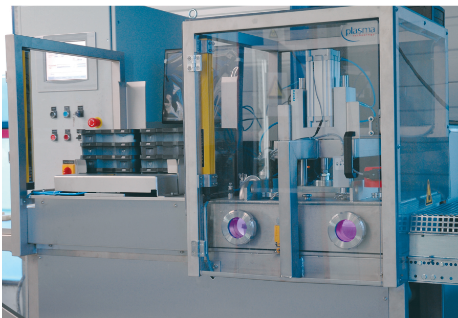
▮ Abb. 1: In einer Beschichtungslinie integrierter Plasma-Spot® Bild: plasma technology GmbH
