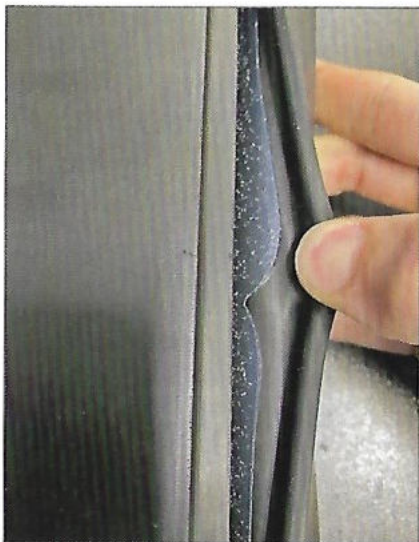
Bild 2: Nach der Plasmabehandlung lässt sich die TPE-Dichtlippe zuverlässig mit dem PE-Gehäuse der Schlossdichtung verkleben
