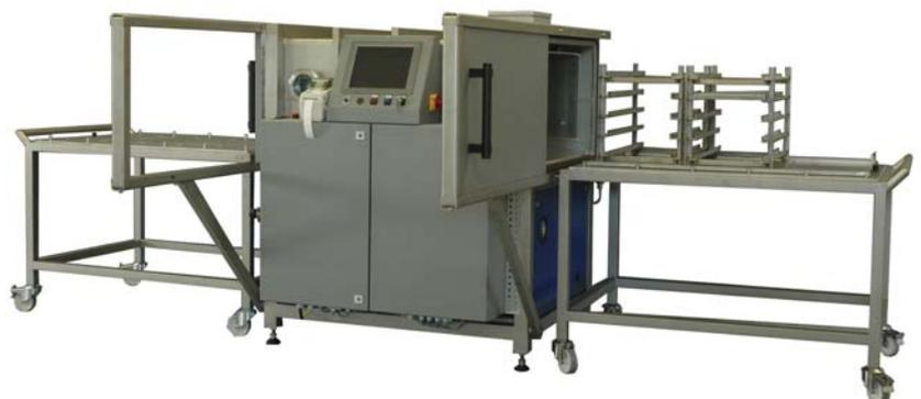
Bild 3: Plasmaanlage mit stirnseitigen Türen.
